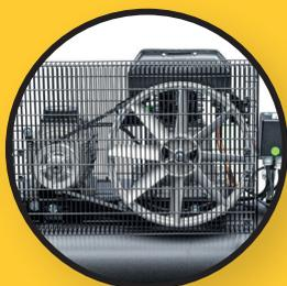
Entraînement puissant et fiable par courroie trapézoïdale trapézoïdale
